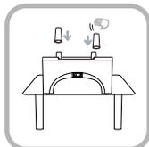
①. Sortir le tambour et les autres accessoires, placer l'appareil (comme indiqué) à l'envers sur la table, sortir les quatre pieds de support et les insérer à tour de rôle dans les positions correspondantes, les tapoter pour assurer l'installation.
