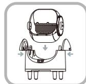
②. Stellen Sie die Maschine auf einen harten und ebenen Boden, installieren Sie zuerst die Trommel und drücken Sie dann beide Seiten des Griffs mit der Hand nach innen, um sie zu installieren.
