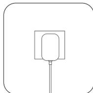
Inserire l'estremità dell'adattatore di corrente nella presa elettrica
