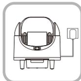
④. Collegare l'alimentazione, connettersi al WiFi, inserire un oggetto di peso noto (superiore a 500 grammi) nella macchina, rimuoverlo dopo 10 secondi e verificare che il peso visualizzato sia preciso.
