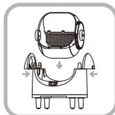
②. Posizionare la macchina su un pavimento duro e piatto, installare prima il tamburo e poi premere manualmente verso l'interno entrambi i lati della maniglia per installarla.
