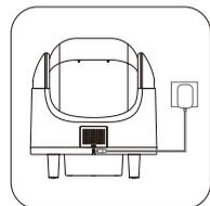
Inserire la porta dell'adattatore di corrente nel foro posteriore del prodotto
