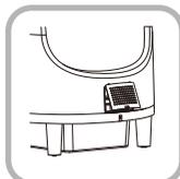
①. Individuare la piastra di copertura sul lato e premere i due fermi sulla piastra di copertura, quindi rimuovere la piastra di copertura.
