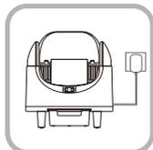
④. Conectar a la fuente de alimentación, conectar a WiFi, colocar un objeto de peso conocido (más de 500grams) en la máquina, retirarlo después de 10 segundos, y comprobar si el peso mostrado es exacto.
