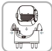
②. Coloque la máquina sobre un suelo duro y plano, instale primero el tambor y, a continuación, presione ambos lados del mango hacia dentro con la mano para instalarlo.
