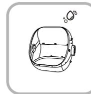
⑥. El cilindro rotativo se limpia directamente con agua
