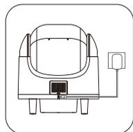
Inserte el puerto del adaptador de corriente en el orificio posterior del producto
