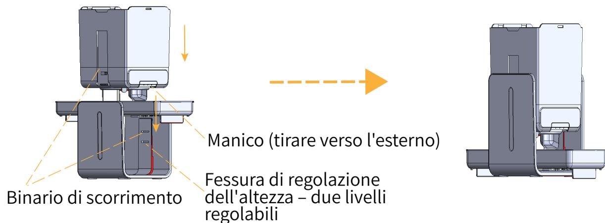
⑤ Installare le ciotole in acciaio inox sinistra e destra. Aggiungere il cibo nelle ciotole. Rimuovere l'imballaggio esterno del disidratante, posizionarlo nel comparto del disidratante e chiuderlo saldamente. Poi, rimontare il coperchio superiore (come mostrato di seguito).
