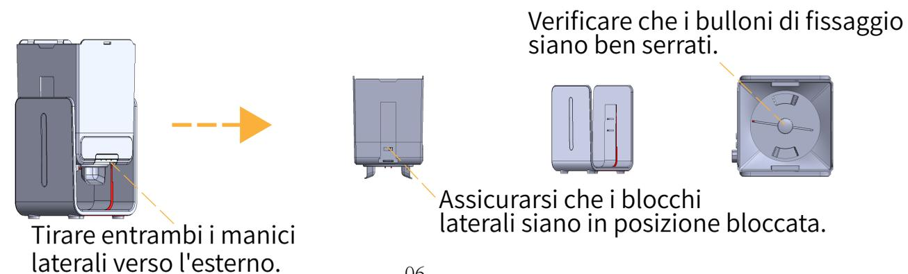
③ Capovolgere l'unità principale, quindi spingere il supporto per ciotola nel foro del meccanismo di erogazione, seguendo la direzione della freccia sulla fessura, finché non si incastra in posizione. Successivamente, fissare i due supporti per ciotola seguendo le direzioni delle frecce (come mostrato di seguito).
