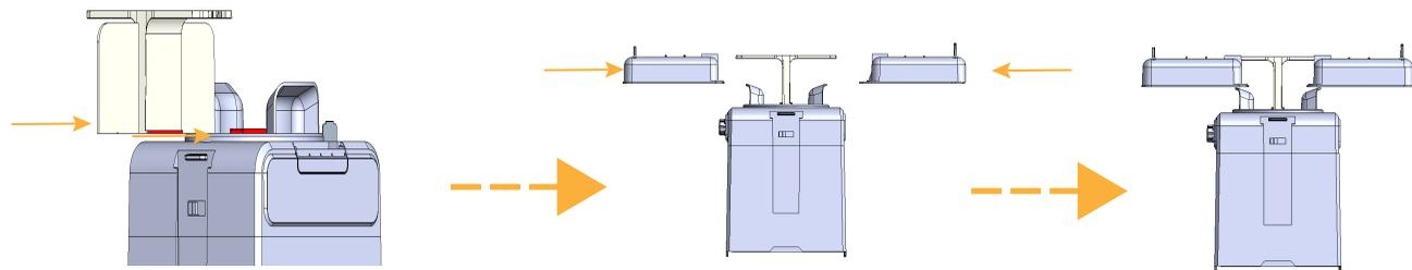
④ Tire de las asas, alinee las ranuras a ambos lados del contenedor de alimentos con las ranuras en el soporte del cuerpo y deslice hacia abajo hasta la altura de instalación deseada (hay dos posiciones de altura disponibles). Suelte las asas y la unidad principal se deslizará automáticamente en su lugar y se bloqueará de forma segura con el pestillo en el cuerpo (como se muestra a continuación).
