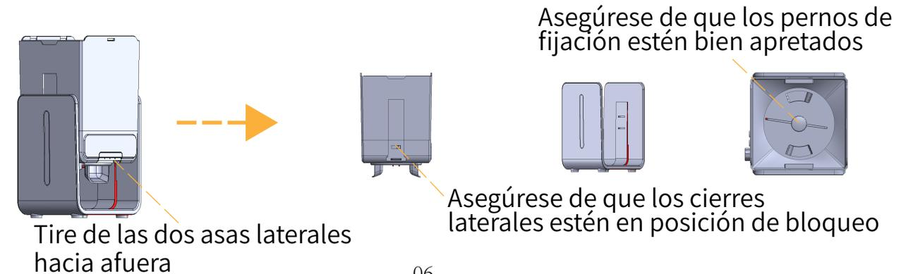
③ Gire la unidad principal, luego empuje el soporte del tazón en la ranura en la parte inferior del mecanismo de dispensación, siguiendo la dirección de la flecha en la ranura, hasta que encaje en su lugar. Luego, instale los dos soportes de tazón siguiendo las direcciones de las flechas (como se muestra a continuación).
