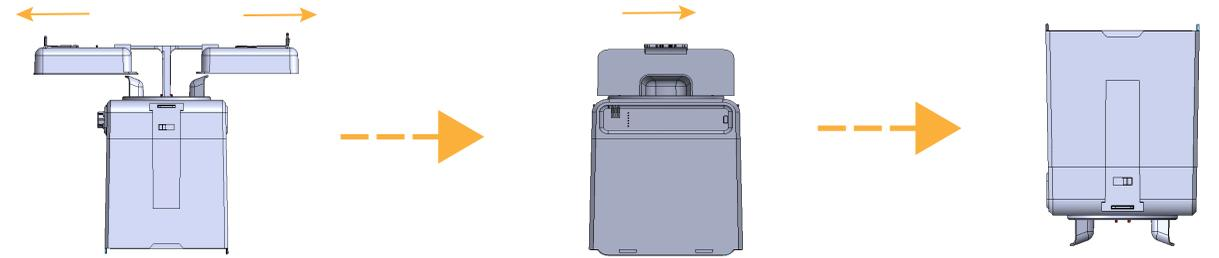
③ Coloque el seguro entre el depósito de alimento y el mecanismo de dispensado en la posición de desbloqueo. Gire la unidad principal, luego gire el perno de fijación dentro del depósito en sentido antihorario hasta que se afloje por completo. Retire la pala agitadora, el contenedor de comida y el disco dosificador individualmente para su limpieza (como se muestra a continuación).
