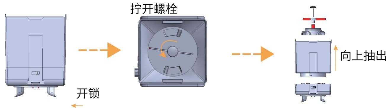
④清洗后用干布擦净表面的水渍后原样安装回去即可以使用
