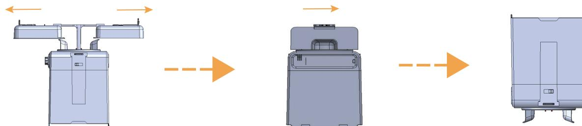
③拨动储粮桶与分粮机构的锁扣,处于开锁状态,把主机翻转过来,将储粮桶内紧固螺栓逆时针旋转直到完全松开,依次取下扫粮片、储粮桶、分粮转盘(如下图)进行清洗。
