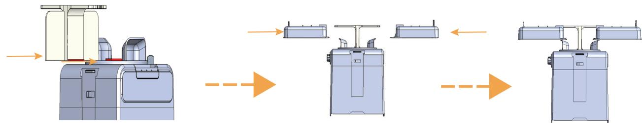
④拉住把手,将储粮桶两侧槽位对准机身支架的槽口,下滑到需要安装的高度(共两个档位高度)。松开把手,机身将自动滑入支架卡扣卡紧(如下图)。
